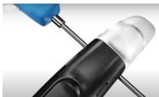
2. הסירו את ההוק (זווית הפלסטיק) מהמעבד בעזרת הכלי המיועד לכך. הקפידו לעשות זאת מעל שולחן כדי שהפין האוחז את ההוק לא יאבד.
